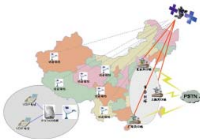
图 7 iPSTAR 系统用于普遍服务的网络拓扑图
